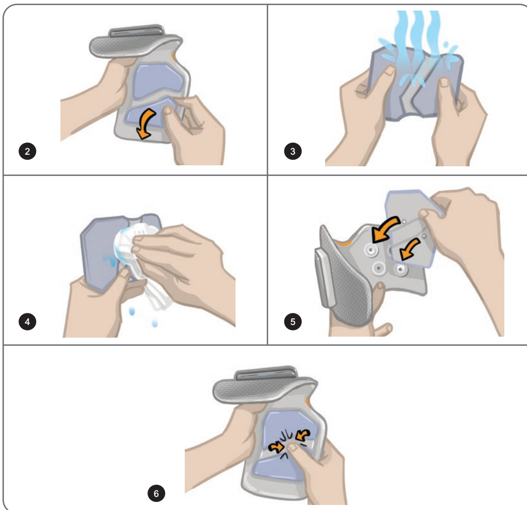
Figura 11-3: Substituição do eletrodo de encaixe rápido
