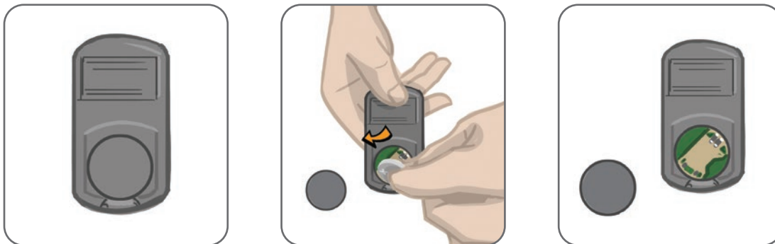
Figura 11-2: Substituição da bateria da unidade de controle
