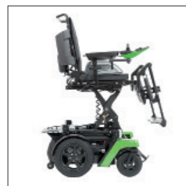
EC026 Elevação elétrica de assento até 35 cm
