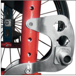
MG 86 Prolongamento – distância entre eixos
