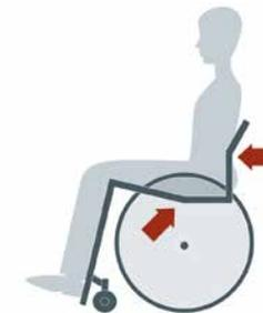
O desenho do assento ergonómico com a sua secção em cunha e a secção horizontal optimiza a estabilidade pélvica, facilita a propulsão da cadeira e minimiza a fricção para proteger a pele.
