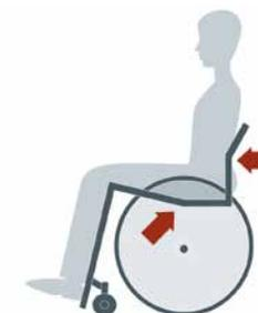
O formato do assento ergonómico com a secção em cunha e a secção horizontal optimiza a estabilidade pélvica, facilita a propulsão da cadeira e minimiza a fricção para proteger a pele.
