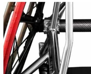
Tubo do eixo em carbono para máxima rigidez e leveza. Fixado à armação através de abraçadeiras, permite um ajuste fino do ângulo das rodas traseiras (toe in/toe out) para um rolamento perfeito.
