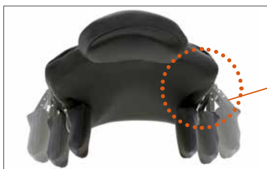
Suporte lateral abatível – Ajustável em altura, ângulo e largura (até 10 cms), graças ao seu desenho de hardware com 2 pontos pivot.
